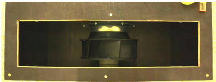
Placez et fixer le ventilateur en place en le fixant au panneau 05 et le panneau de montage.
