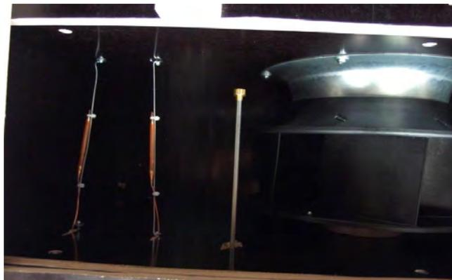
Lors de l'insertion du fil de cuivre à partir du commutateur de température faire attention qu'il passe dans le centre la chambre de ventilateur.
