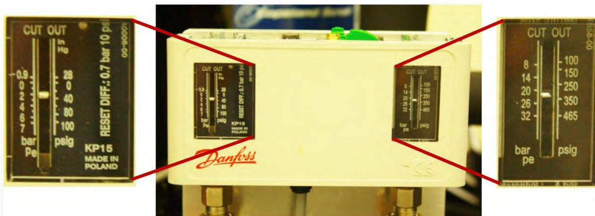
Réglez le minimum de pression à 1,5-2,0 bar et le maximum de pression à 20-25 bar.
