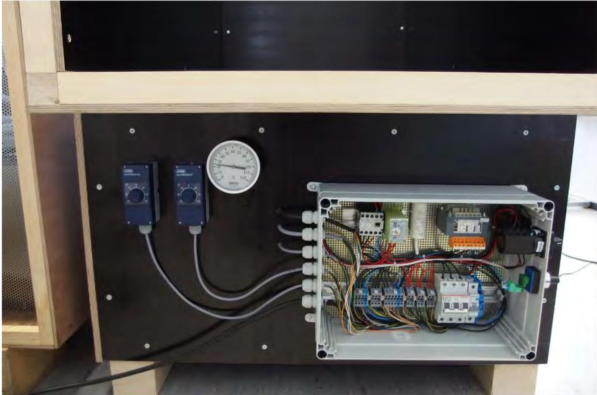
Attacher le cabine électrique, jauge de température analogique, et deux commutateurs de température à la Planche 11 du séchoir.
