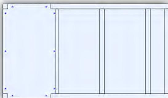
Placez et fixer la Planche 02 (côté intérieur vers le haut) sur le dessus des barres, rincer à la fin du séchoir.
