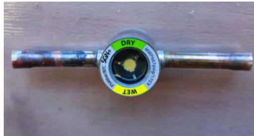
Débrancher les tuyaux de réfrigérant et vérifier le verre de vue pour vous assurer que la couleur représente SEC et qu'il n'y a pas de bulles visibles.
