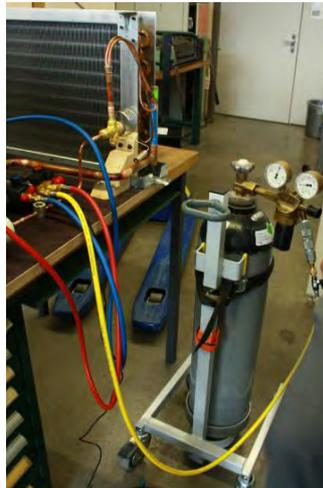
Utiliser de l'azote sous pression pour pressuriser le système à 10 bar.
