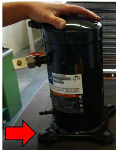
Insérez bagues en caoutchouc dans les points de fixation pour le compresseur.
