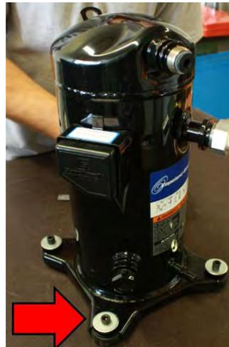
Placer et fixer le compresseur en utilisant des inserts filetés fendue, et la rondelle 04.
