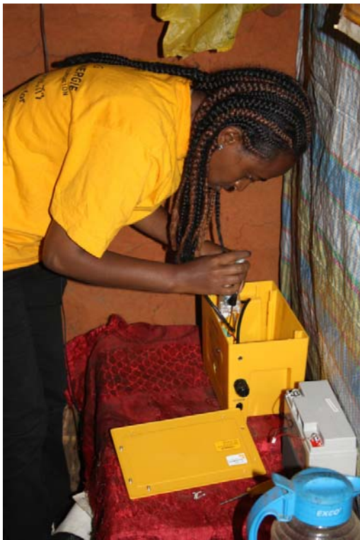
Solar-Home-System mit Anzeige der Laufzeit für die angeschlossenen Applikationen
