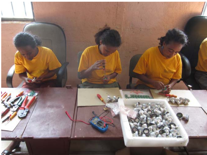
Zusammenbau der LED-Chips zu einer hoch effizienten LED (Aufnahme im Solar Valley Ethiopia)
