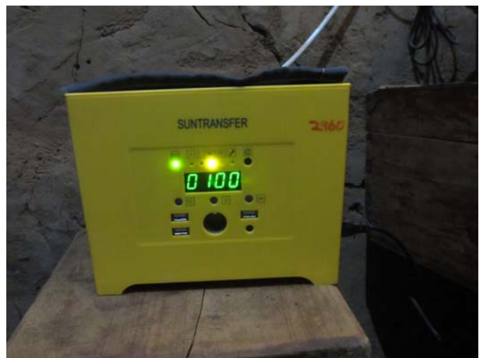
Solar-Home-System mit Anzeige der Laufzeit für die angeschlossenen Applikationen
